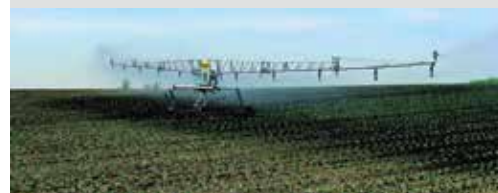
Les rampes montées sur enrouleur permettent d'irriguer une largeur allant jusqu'à 66m
